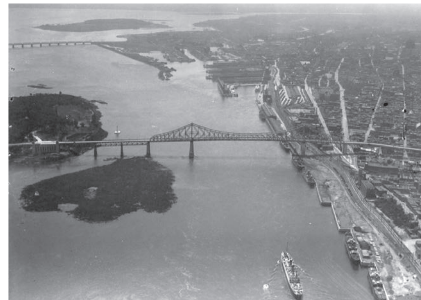
Cette photographie montre le rétrécissement du fleuve généré par la présence des îles Sainte-Hélène et de la Ronde qui avait pour effet d'accélérer le courant et de provoquer une rupture de charge à une ancienne époque. Date inconnue. Source : Archives de la Ville de Montréal. Collection de l'Écomusée du fier monde.
