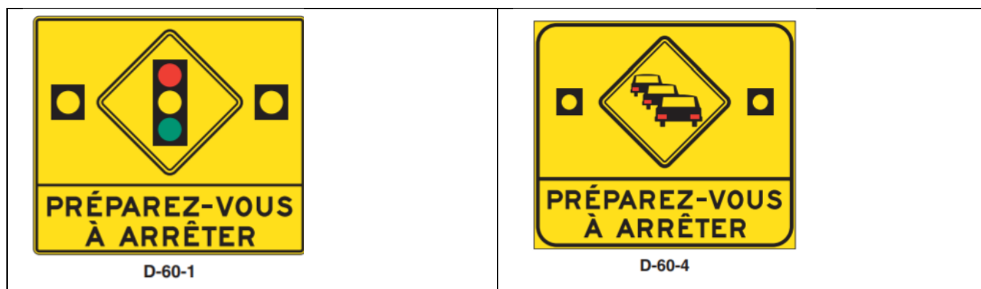
Figure 46 – Exemple de panneaux « Préparez-vous à arrêter »
