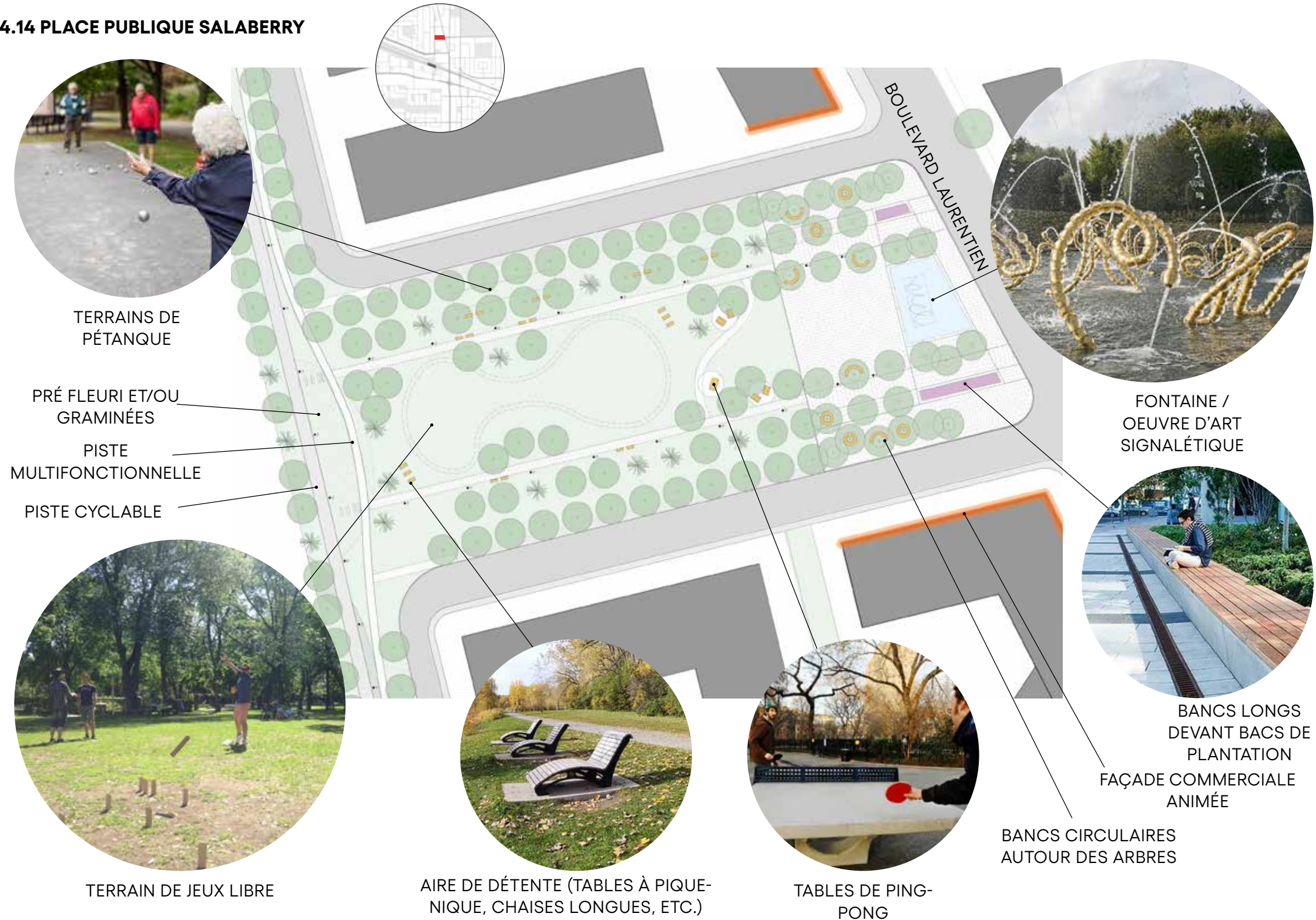
Fig. 245. Exemple d'aménagement détaillé pour la place Salaberry, échelle 1:750
