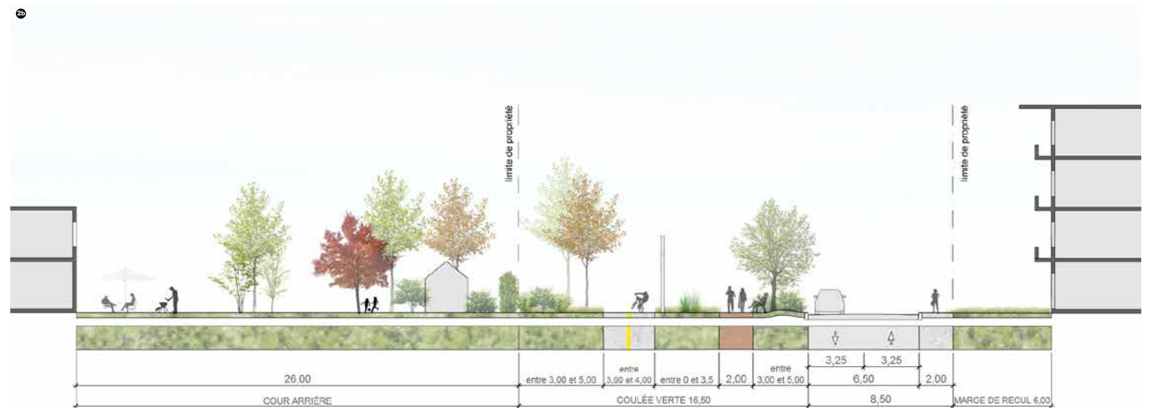
Fig. 195. Coupe type d'une piste multifonctionnelle
