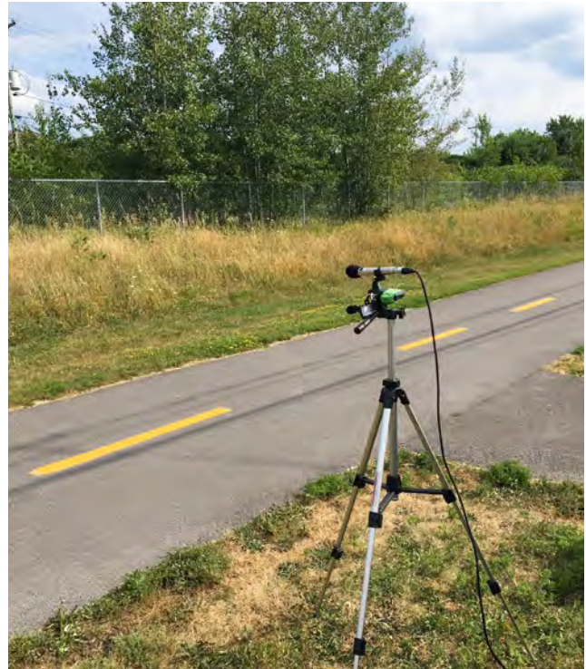
Mesure de bruit aux abords de la voie ferrée et de la piste cyclable jouxtant la rue Croteau à Repentigny. Source : Tony Leroux, 2019.
