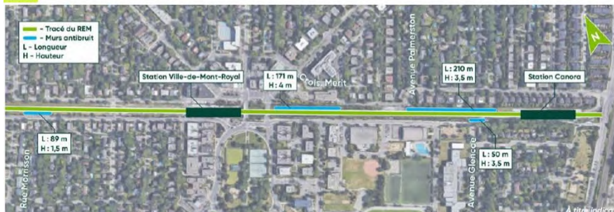
Figure 12 : Emplacement des segments de murs antibruit.
