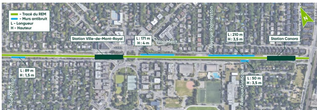
Figure 12 : Emplacement des segments de murs antibruit.
