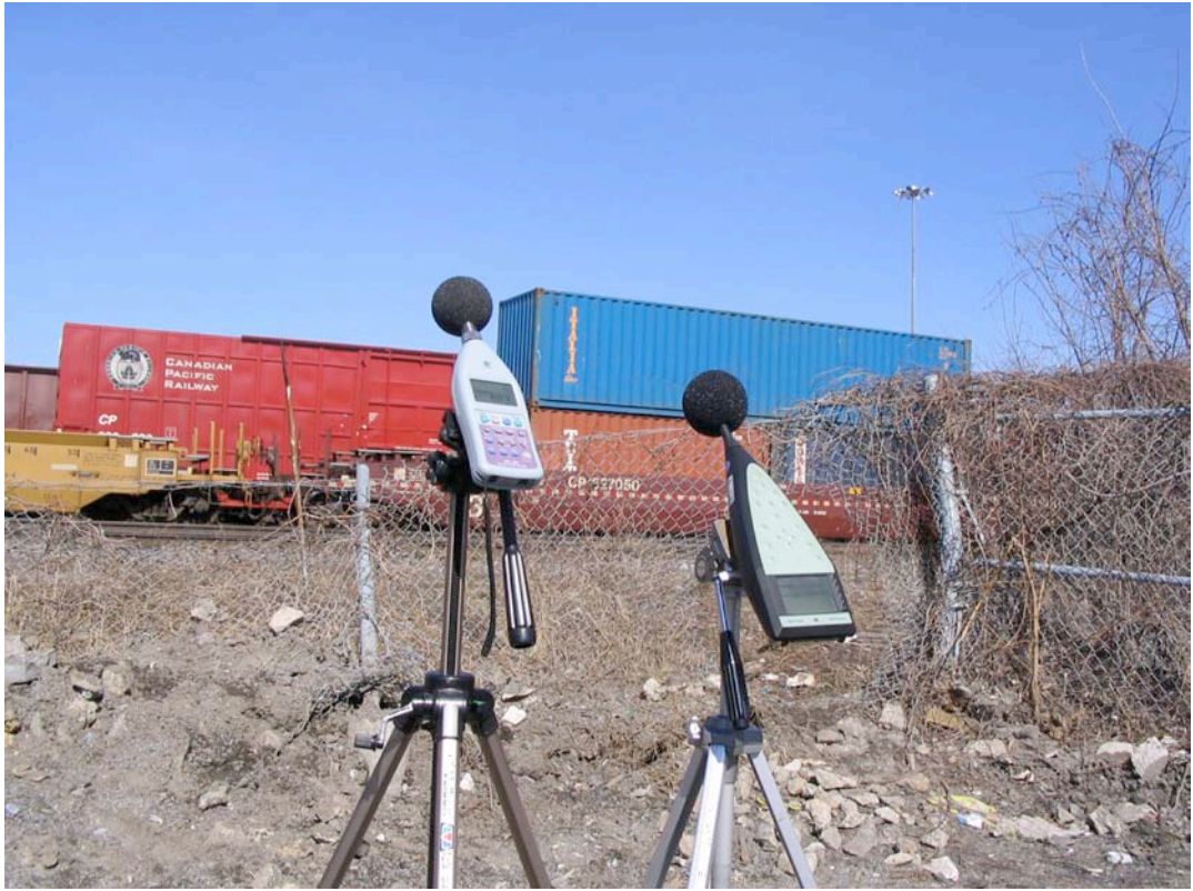
Enregistrement digital et analyse statistique spectrale au passage d'un train de marchandise
