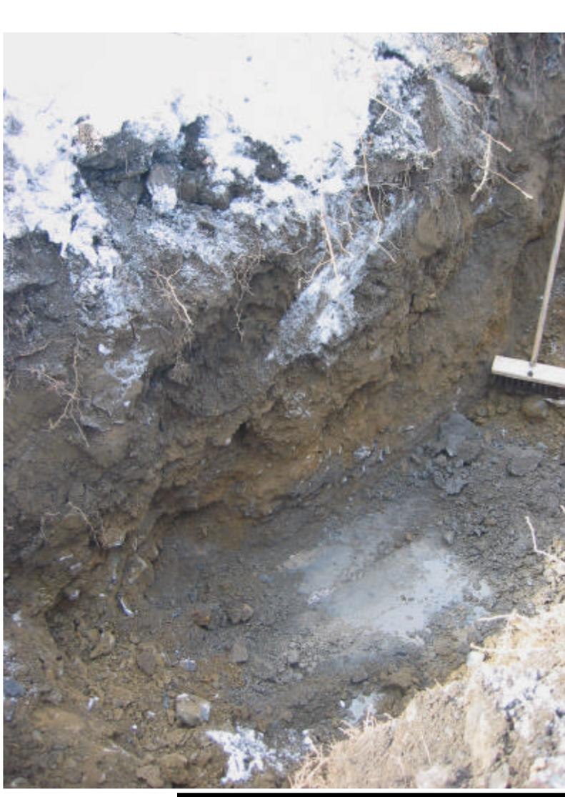
Photo no 11 : Surface plane et lisse du socle rocheux, à la tranchée d'exploration TE-05-51.
