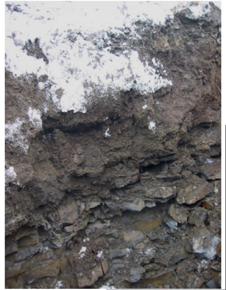
**Photo n° 4.**     →    Horizon de roc fracturé avec matrice composée de silt sableux à la tranchée d'exploration TE-05-42.
