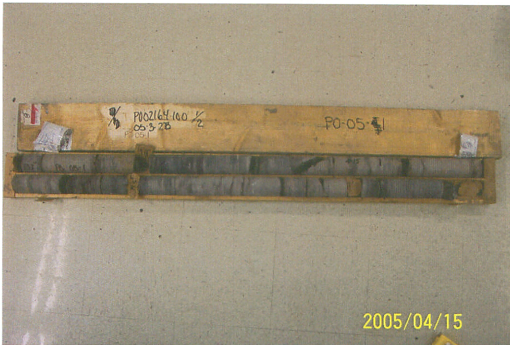
Photo n° 1 : Échantillon de roc carotté dans le forage PO-5-01
