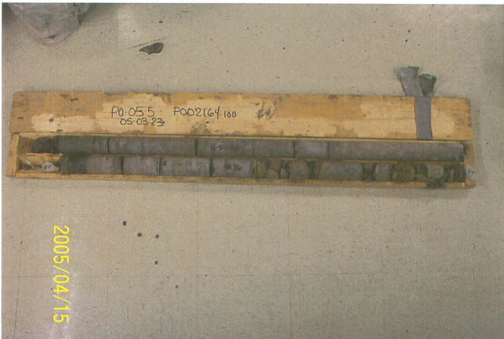
Photo n° 2 : Échantillon de roc carotté dans le forage PO-5-05
