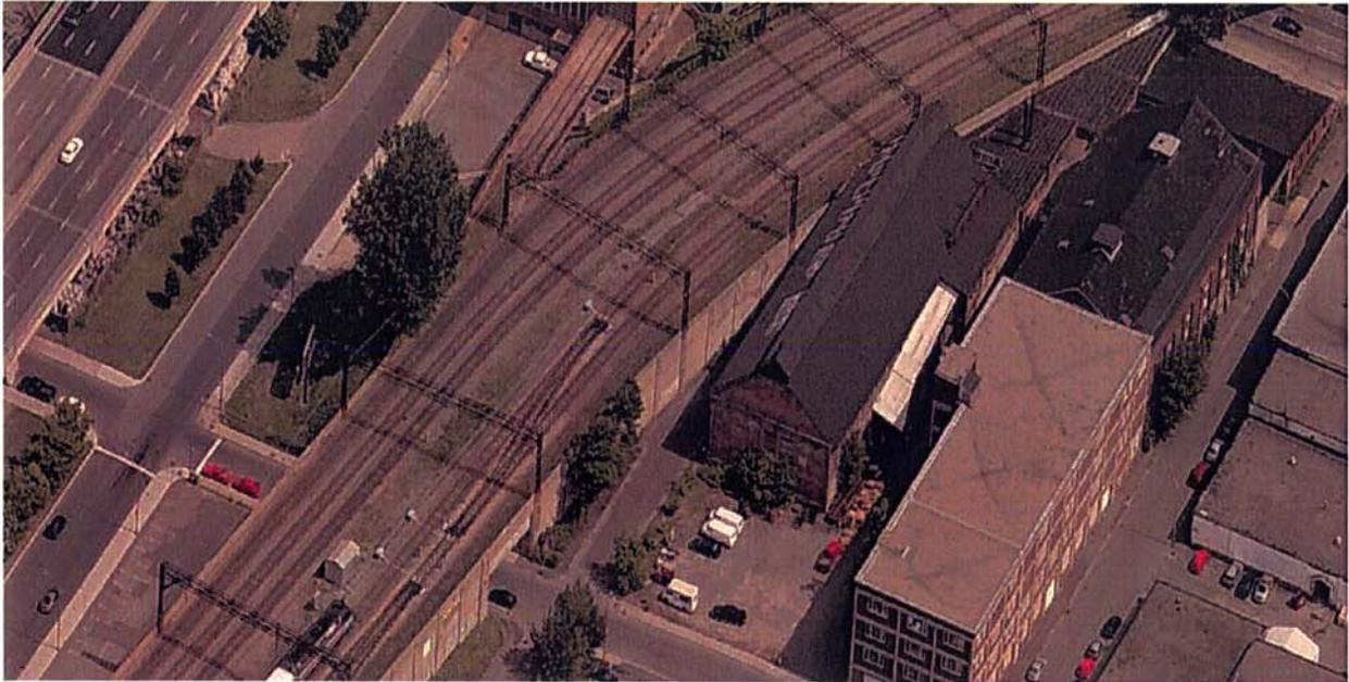
La photo suivante montre le coin sud-est du viaduc Wellington et l'aile de culée située dans l'axe du tunnel à l'étude. À noter la pente de talus de ce côté de l'emprise.
