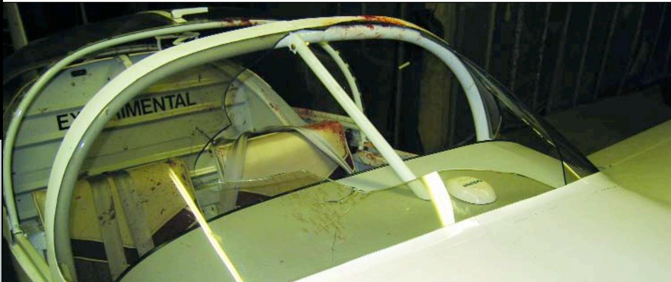
Dommmages causés à un avion Van's RV-6, qui est entré en collision avec un oiseau à une vitesse de 140 nœuds, à 2 500 pieds au-dessus du sol, en conditions d'obscurité totale.
