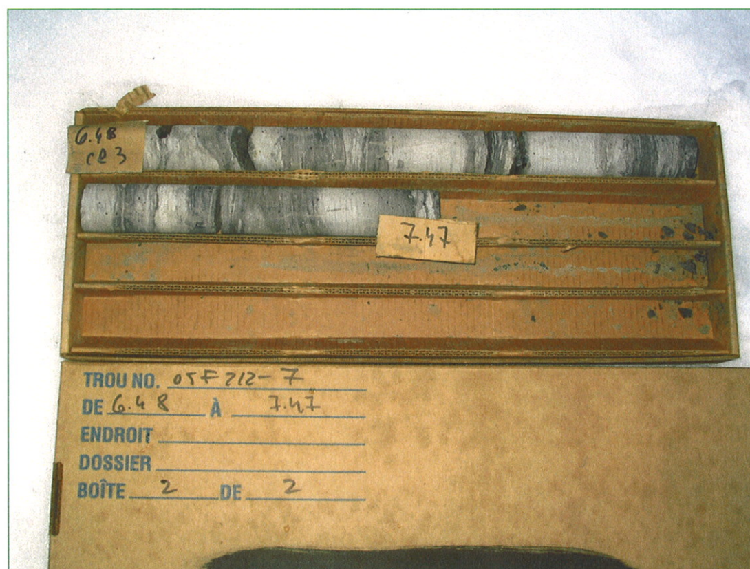
Photo 4 : Carotage du roc
