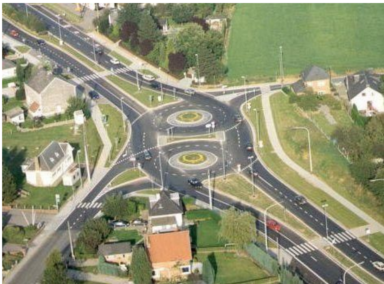
Image 6 : exemple de double carrefour giratoire en Belgique. Lien : http://trobenet.canalblog.com/archives/2010/11/11/19573141.html
