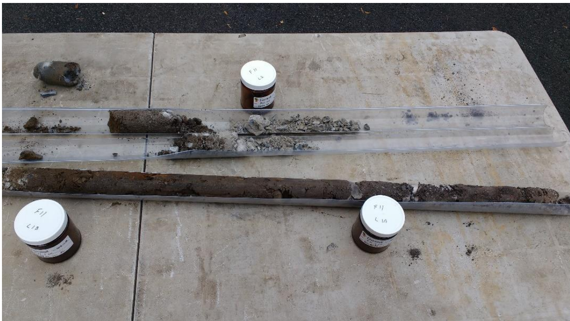
Photographie 6 : remblai au droit de F-11
