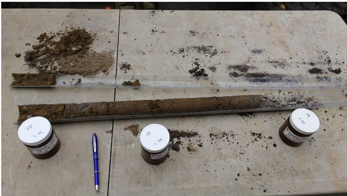
Photographie 7 et 8: remblai et sol naturel au droit de F-8
