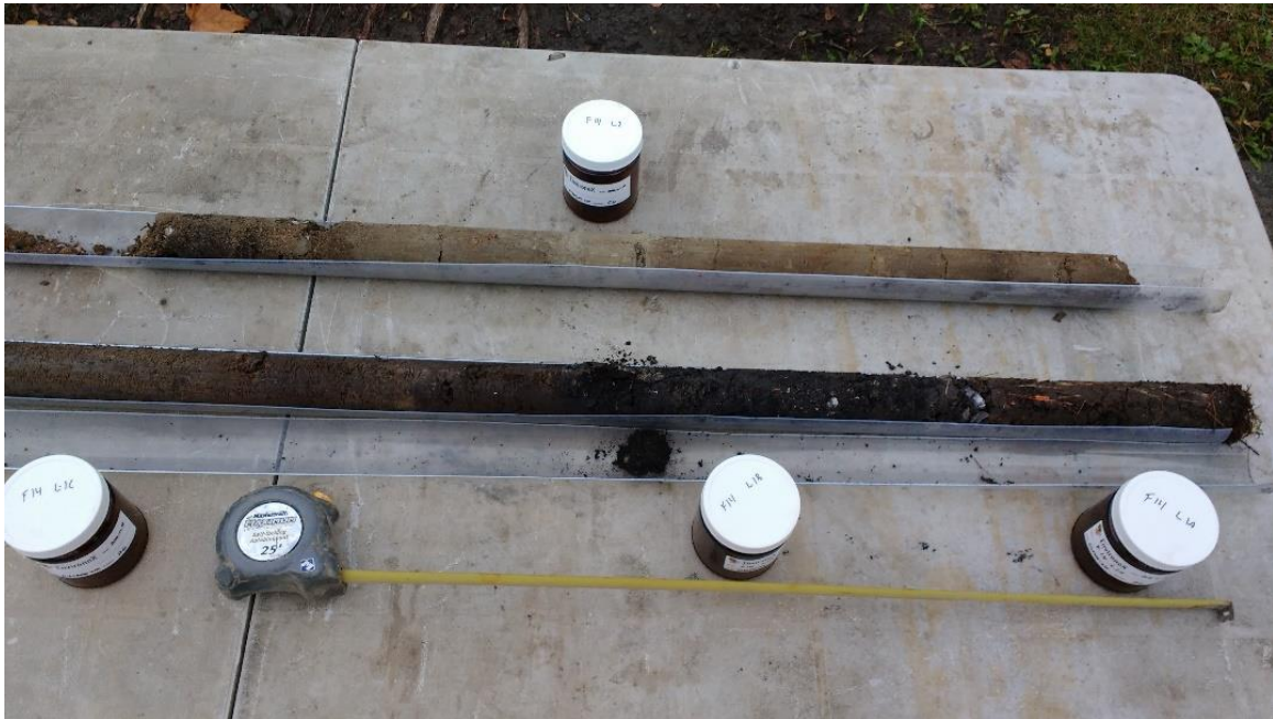
Photographie 5 : remblai et sol naturel au droit de F-14
