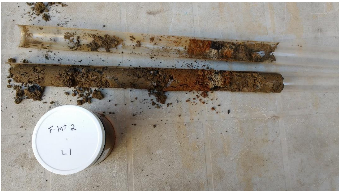
Photographie 10 : remblai au droit de F-INT2
